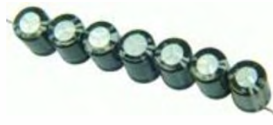
GoldCap-Module mit 7 GoldCaps (7 x 1F in Serie, also 140000µF / 17,5 V)
