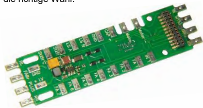
ADAPUS15 mit 1,5 V Niederspannung, 71 x 18 x 4 mm
